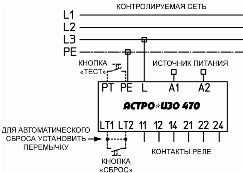
Рис. 3. Схема соединений для трёхфазной сети
